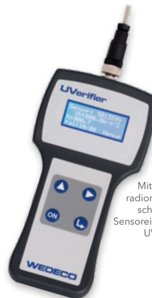
Mit dem mobilen Referenzradiometer UVerifier lässt sich schnell und einfach die UV-Sensoreinrichtung der WEDECO UV-Anlage(n) überprüfen.
